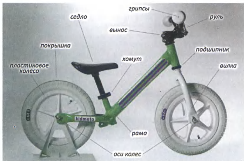
Схема основных узлов и частей конструкции.
