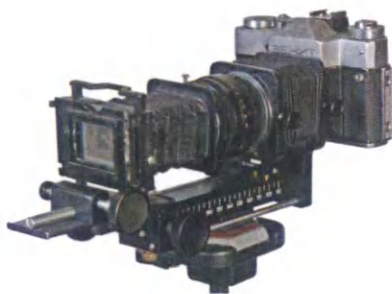
Установка для пересъемки слайдов для фотоаппарата «Зенит».
