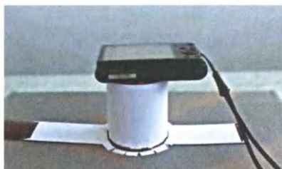
Самодельная установка из бумаги для пересъемки.
